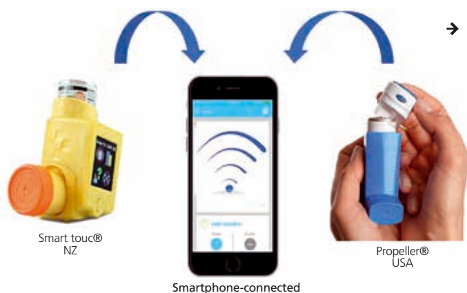
Figura 3. Devices elettronici collegabili allo smartphone per monitorare l'aderenza alla terapia. (Baraldi, comunicazione personale.)
